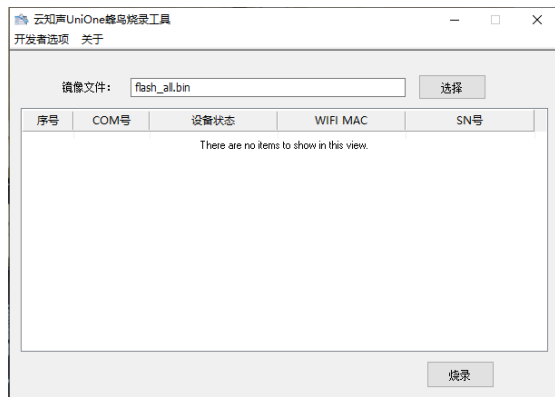
图 1 未识别到 com 口时烧录工具显示
